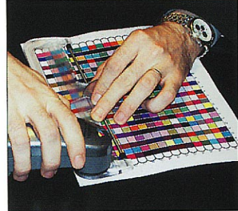
In weniger als fünf Minuten wird mit dem Spektralfotometer das Testtarget gemessen.
